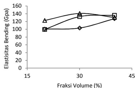
Gambar 9. Diagram hubungan elastisitas bending terhadap fariasi fraksi volume
