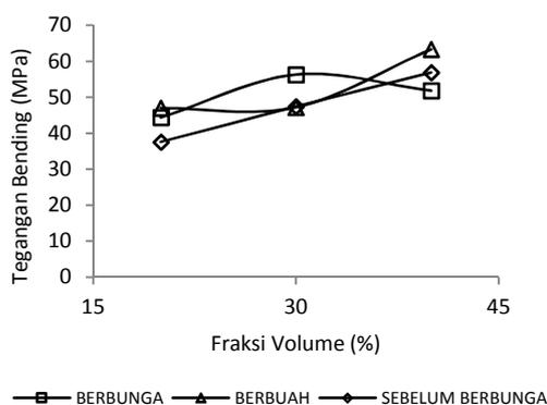
Gambar 8. Diagram tegangan bending terhadap fraksi volume
