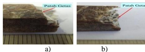
Gambar 16. Fraksi volume serat 32% perlakuan temperatur 200°C selama, a) 1 Jam, a) 3 Jam
