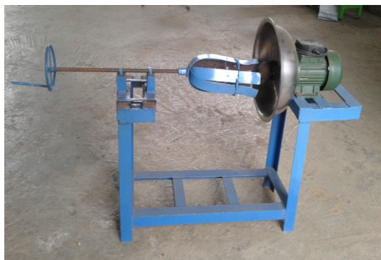
Gambar 1. Modifikasi alat pamarut kelapa system mekanis dengan mata parut \frac{1}{2} lingkaran
