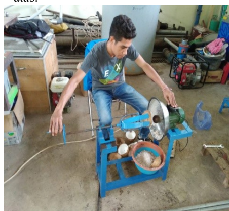
Gambar 2. Pengujian alat pamarut kelapa system Mekanis dengan mata parut \frac{1}{2} lingkaran
