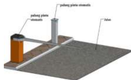
Gambar 5. Letak komponen sitem palang pintu otomatis
