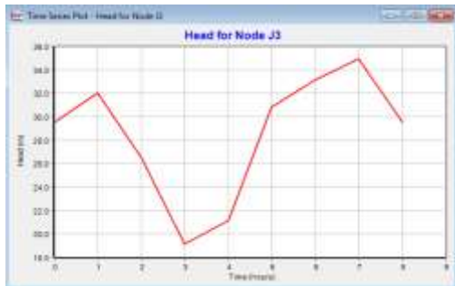
Gambar 8. Variasi head selama 8 jam di simpul 3
