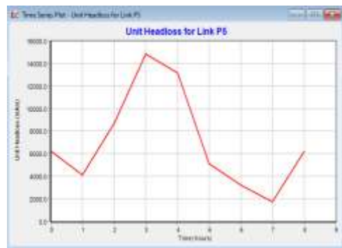
Gambar 10. Variasi rugi head selama 8 jam di pipa 5
