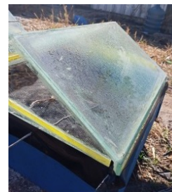
Gambar 12 Pengkabutan uap air pada permukaan kaca basin III
