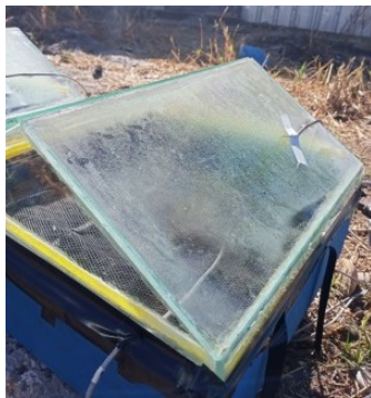
Gambar 10 Pengkabutan Uap air pada permukaan kaca basin II
