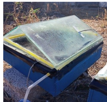
Gambar 8 Pengkabutan uap air pada permukaan kaca basin I
