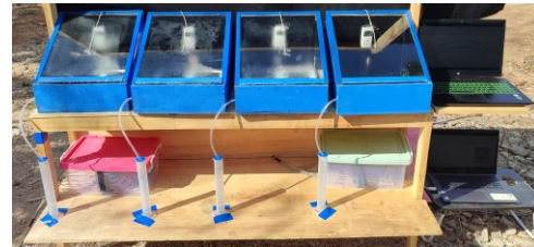
Gambar 3. Set-up pengujian alat distilasi.
