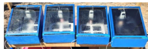
Gambar 8. Proses pengkabutan ( fogging ) pada permukaan kaca basin 1, 2, 3 dan 4
