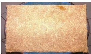
Gambar 7. Spesimen hasil fabrikasi menggunakan metode vacuum bag
