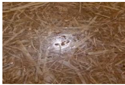
Gambar 9. Cacat pada permukaan spesimen vacuum bag
