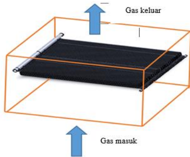
Gambar 9. Gas masuk dan keluar pada pipa low pressure evaporator.
