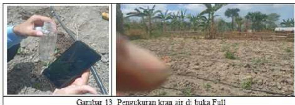
Gambar 13 Pengukuran kran air di buka Full
