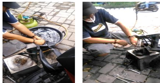
Gambar 4 Pengecekan bocor Sumber : Hasil kegiatan di lapangan UKM Mitra (2020)
