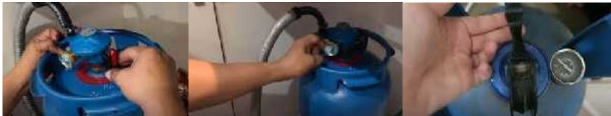
Gambar 5. Sarana Pemasangan Regulator pada Tabung Gas Agar Aman
