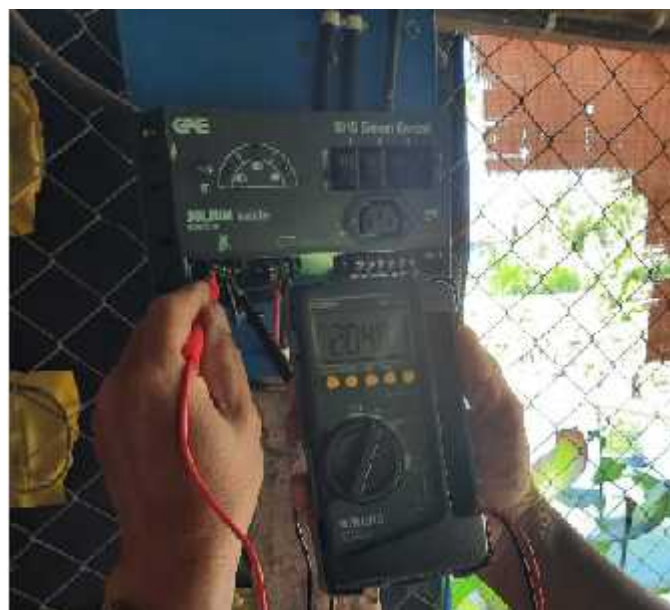
Gambar 1. Pemeriksaan Tegangan Keluaran Solar Sel
