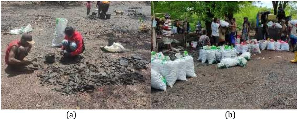
Gambar 5. Hasil Sortasi Mangan berukuran di atas 5 cm (a) dan Pengangkutan ke Gudang (b)
