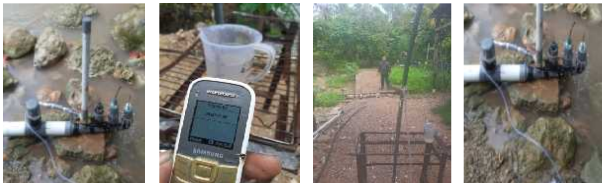
Gambar 7. Desain 3 Katup Buang dan Pengukuran Debit Air
