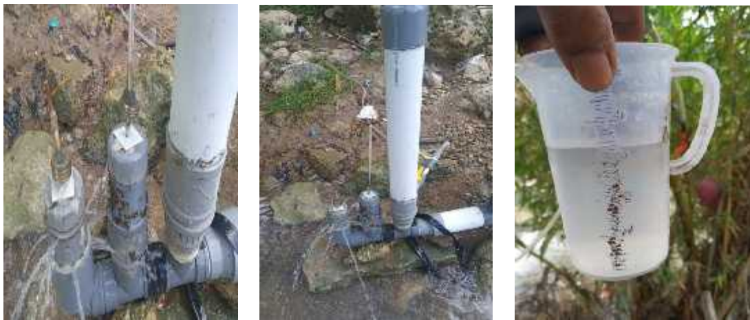
Gambar 6. Rancangan Pompa 2 Katup Buang dan Pengukuran Air
