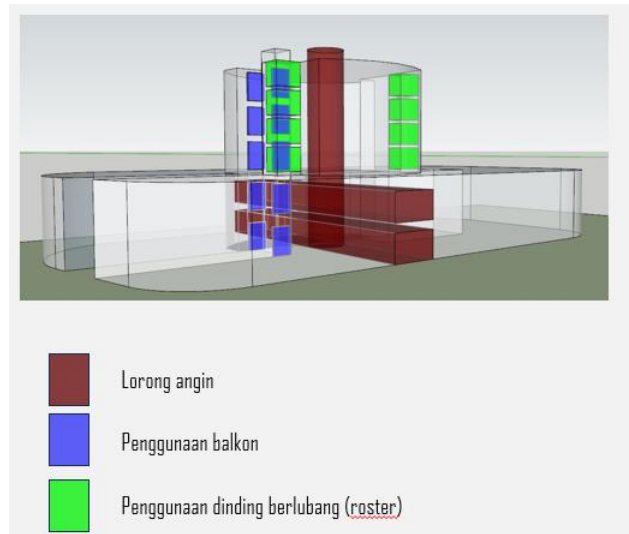
Gambar 8. Konsep penggunaan ventilasi silang
