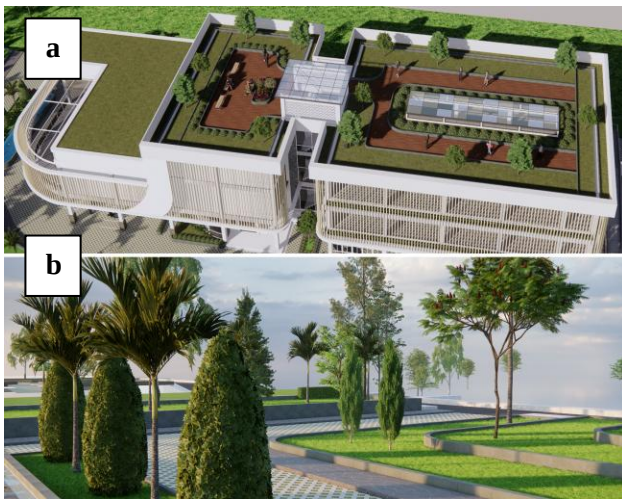
Gambar 7. Pemanfaatan (a) Green Roof dan (b) Penempatan Vegetasi disekitar Bangunan sebagai Adaptasi Desain Bangunan terhadap Iklim Tropis
