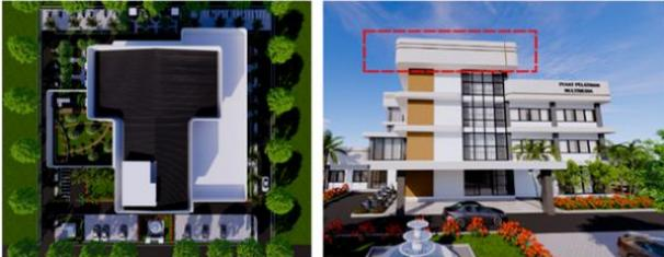
**Gambar 7.** Dinding Parapet pada Tepi Atap
