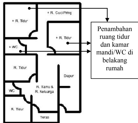
Gambar 12. Tahap akhir pengembangan rumah subsidi dengan menambahkan ruang-ruang lain sesuai dengan kebutuhan dan kemampuan penghuni (atas: sampel di Perumahan Gemstone Regency; bawah: sampel di Perumahan Pondok Indah Matani)
