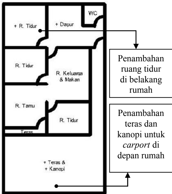
Gambar 11. Tahap akhir pengembangan rumah subsidi dengan menambahkan ruang-ruang lain sesuai dengan kebutuhan dan kemampuan penghuni (atas: sampel di Perumahan Gemstone Regency; bawah: sampel di Perumahan Bello Royal Residence)
