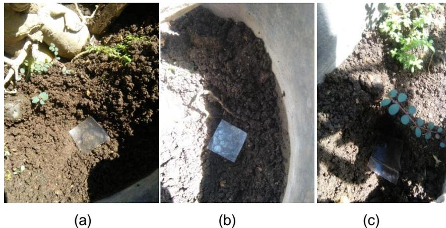
Gambar 2. Uji Biodegradabilitas (a) bioplastik ERL, (b) bioplastik ERL dan kitosan, (c) bioplastik ERL dan natrium benzoat
