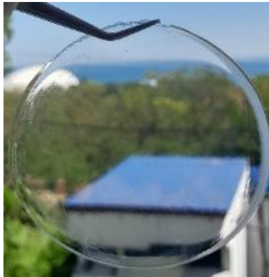
Gambar 1. PIM P3 yang diproduksi dengan komposisi optimum 50% PVC, 40% D2EHPA, dan 10% AO
