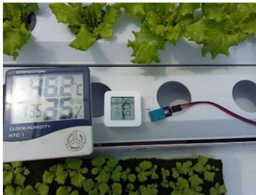
Gambar 5. Percobaan Mengukur Suhu dan Kelembaban Menggunakan DHT11, HTC01, dan Meiji
