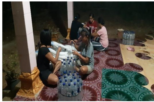
Gambar 2. Pemilihan botol bekas air mineral dan penggabungan menjadi 1 modul berisi 19 botol plastik
