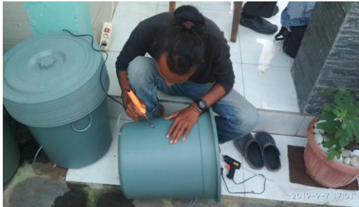
Gambar 7 Pembuatan Lubang untuk Pemasangan Selang pada Wadah Kompos
