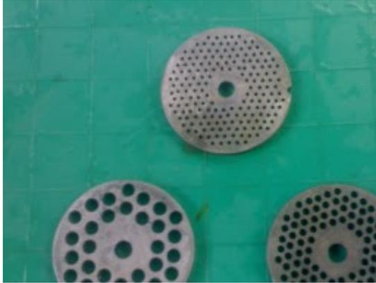
Gambar 5. Tools cetakan pelet
