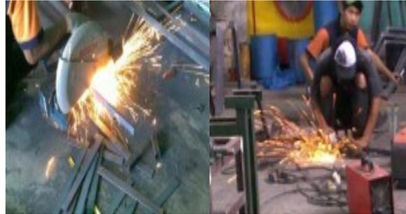
Gambar 3. Pemotongan besi untuk dudukan mesin pelet.
