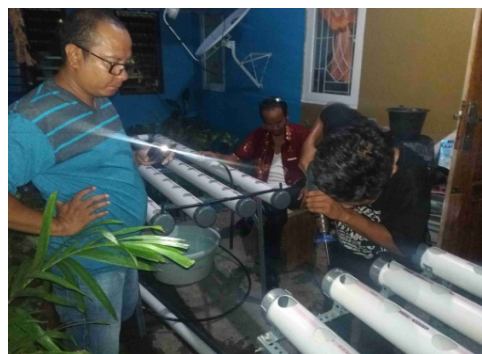
Sumber : Laporan akhir kegiatan I b M Gambar.10 Pembuatan Lubang Untuk Saluran Air
