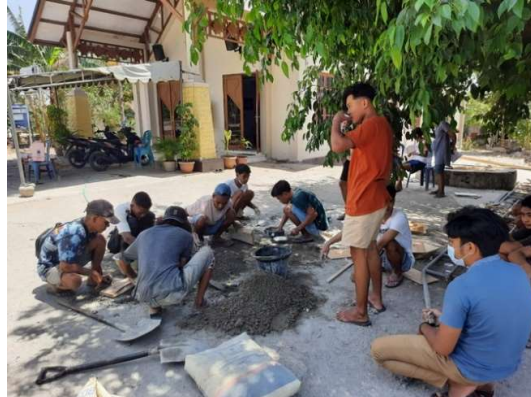
Gambar 1. Proses membuat campuran paving block
