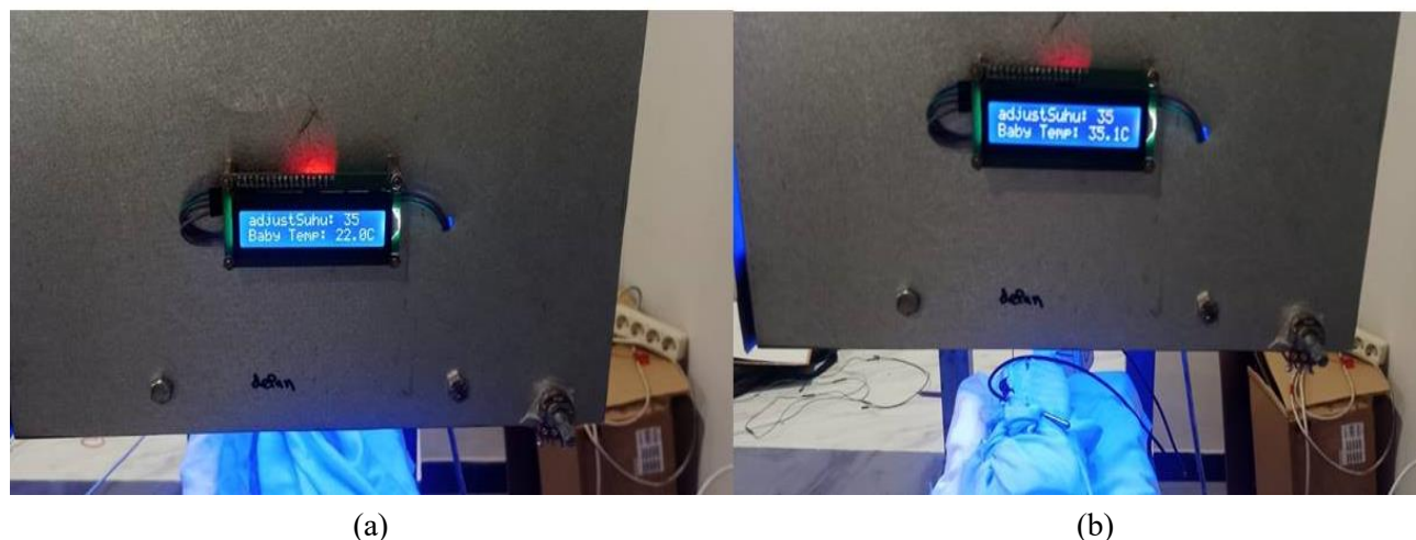
Gambar 4 pengujian alat (a) suhu awal sampel; (b) suhu sampel mencapai set point
