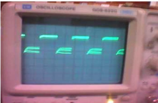
Gambar 7. Bentuk Gelombang Output NAND-1
