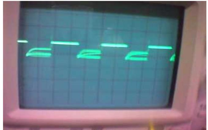
Gambar 8. Bentuk Gelombang Output NAND-2
