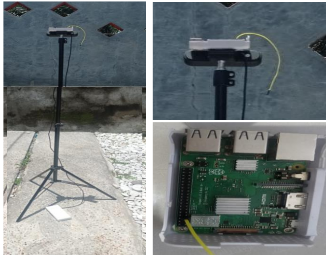
Gambar 4. Konfigurasi Pemancar Skala Lab
