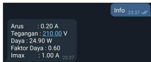
**Gambar 7** Hasil pengujian monitoring arus dan tegangan jala-jala listrik
