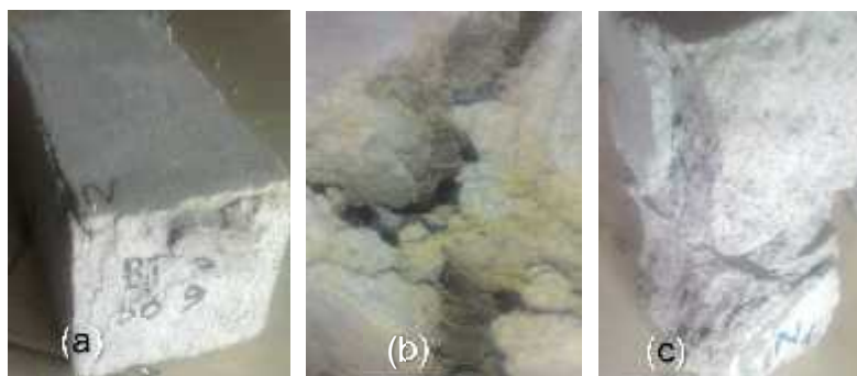
Gambar 6. (a) Benda uji masih tetap utuh setelah melalui uji kuat tekan, (b) Serat buah lontar tidak terputus saat benda uji dihancurkan, (c) Benda uji tanpa menggunakan serat menjadi hancur saat dilakukan pengujian kuat tekan.
