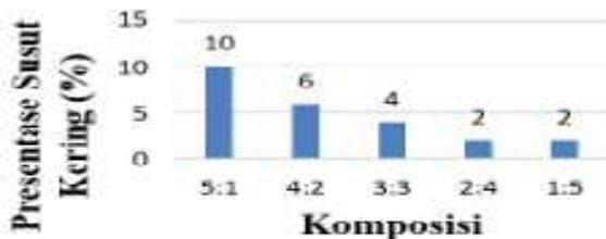
Gambar 1. Pengujian Susut Kering
