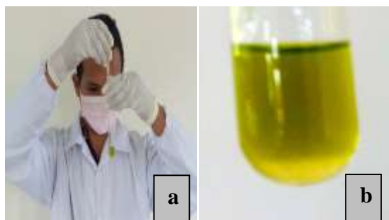
Gambar 5. Hasil uji tanin dengan pereaksi gelatin 10 %. Ket. (a). penambahan gelatin 10 %. (b). terbentuknya endapan putih
