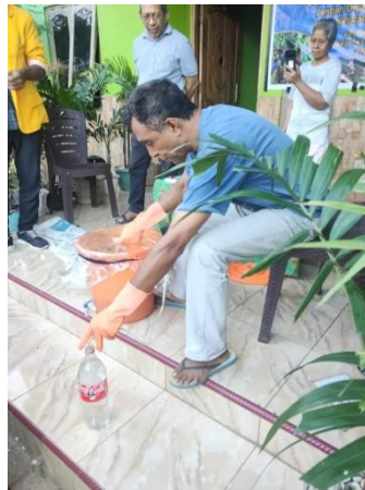
Gambar 9. Instalasi selang penyalur ke luar gas dari proses fermentasi
