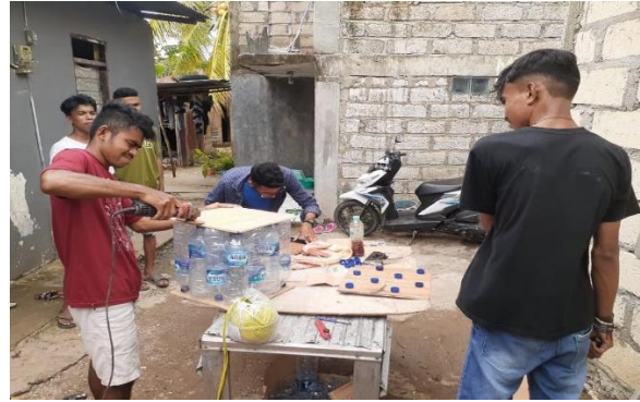
Gambar 4.3. Proses Menyatukan Botol Sesuai Dengan Bentuk Yang Diinginkan
