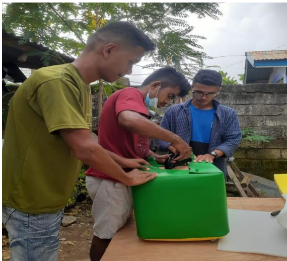
Gambar 4.7. Pemasangan kulit sofa finising terakhir
