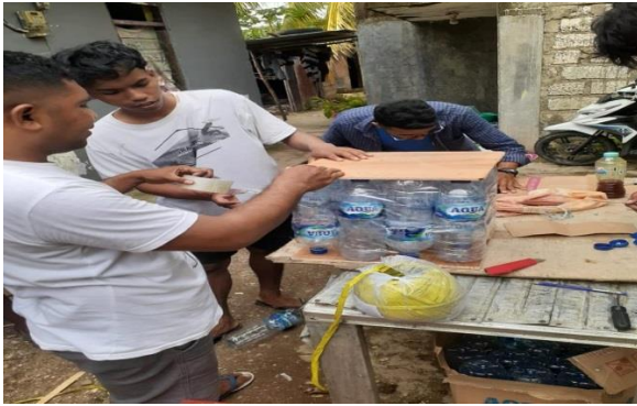
Gambar 4.3. Proses Menyatukan Botol Sesuai Dengan Bentuk Yang Diinginkan
