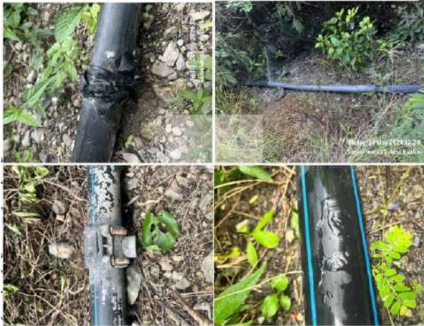
Gambar 7. Instalasi Pipa Air yang Rusak di Titik Tertentu
