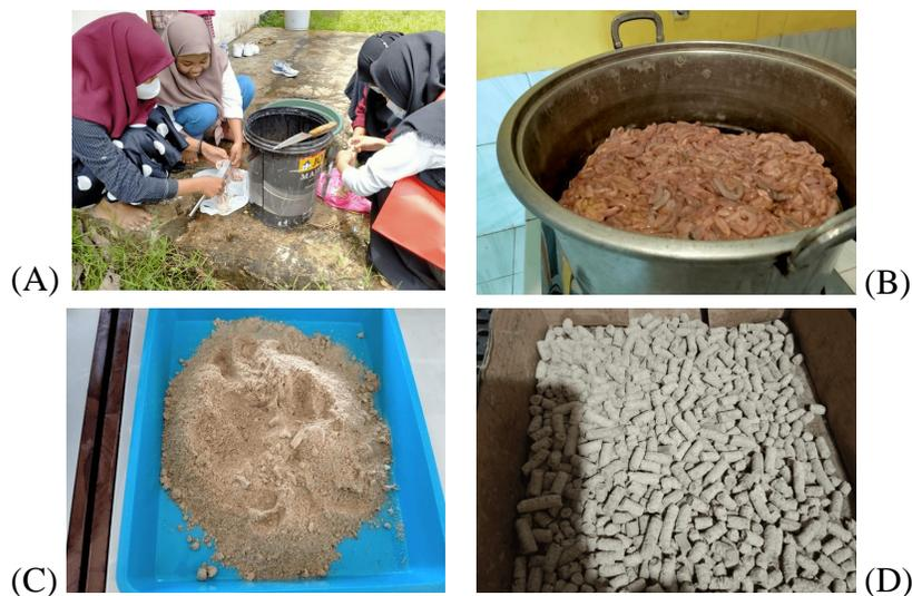
**Gambar 4.** Proses pembuatan pakan ikan lele (A) Pembersihan usus; (B) Pengukusan usus, (C) Tepung usus yang sudah siap diolah; dan (D) *Pellet* usus yang dihasilkan
