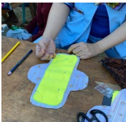
Gambar 6. Langkah 5 yaitu meletakkan susunan lapisan kain (microfiber, katun dan kain taslan) dengan bantuan jarum pentul yang sudah digunting sesuai pola.
