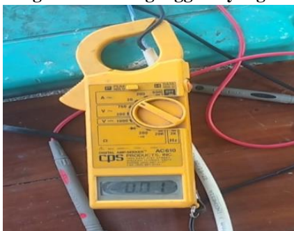
Gambar 6 Menunjukkan pengukuran arus gangguan yang melewati ELCB sebesar 10 [mA].
